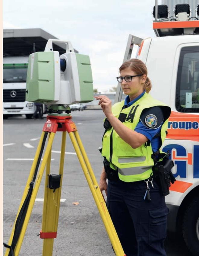
▲ Gli strumenti utilizzati dalla polizia sono sempre più sofisticati. Uno scanner 3D permette ad esempio di misurare milioni di punti al secondo.
